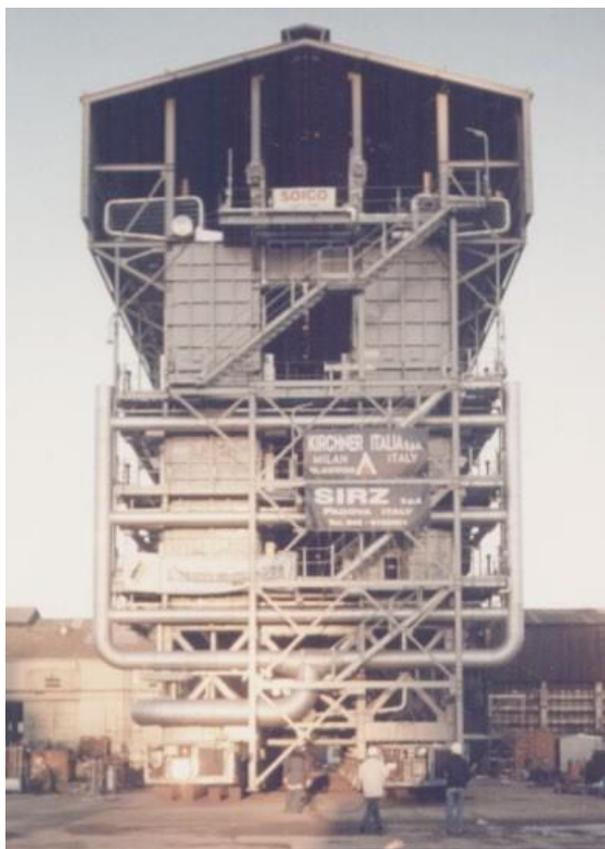
Мы обладаем большим опытом в изготовлении печей полностью в модульном исполнении и в комплекте с огнеупорной футеровкой, змеевиками, горелками, трубной обвязкой, контрольно-измерительными приборами, теплоизоляцией, площадками для обслуживания и системой освещения.
